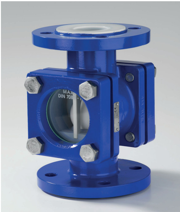
SBC Kropp i gjutstål 1.0619 (WCB) / PFA lining, med solid PTFE Kula
